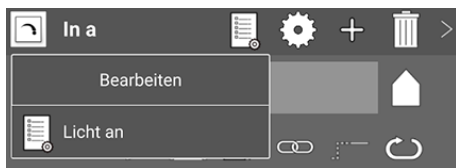
Abbildung: Für den Eingang In a steht das Eingangsmakro Licht an zur Auswahl.
