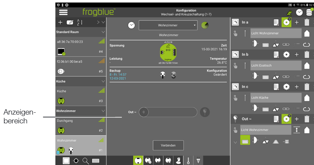
Abbildung: Der Anzeigenbereich im Konfiguration Bildschirm.
