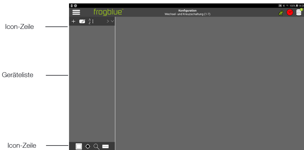
Abbildung: Konfiguration Bildschirm der frogblueProject App mit der Geräteliste und den beiden Icon-Zeilen.
