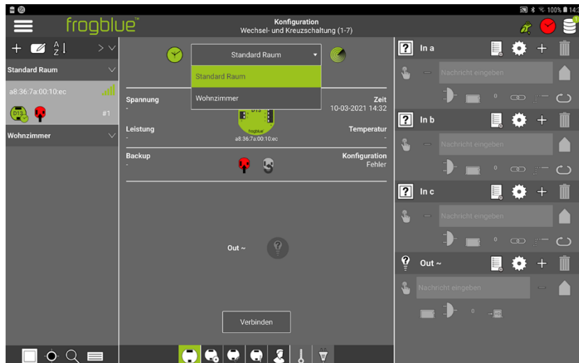
Abbildung: Auswahlliste zur Auswahl des Raums im Anzeigenbereich.
