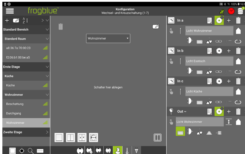
Abbildung: Die Nutzeransicht im Anzeigenbereich mit einer Auswahl an konfigurierbaren Taster.
