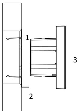
Den Metallrahmen (1) an einer Gerätedose montieren.
