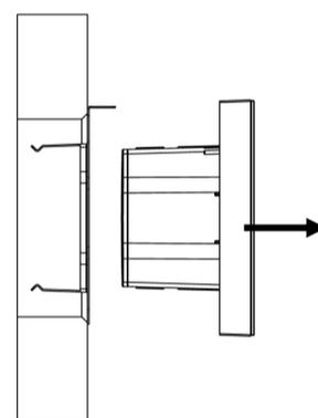
Das Display seitlich greifen und aus der Halterung ziehen.
