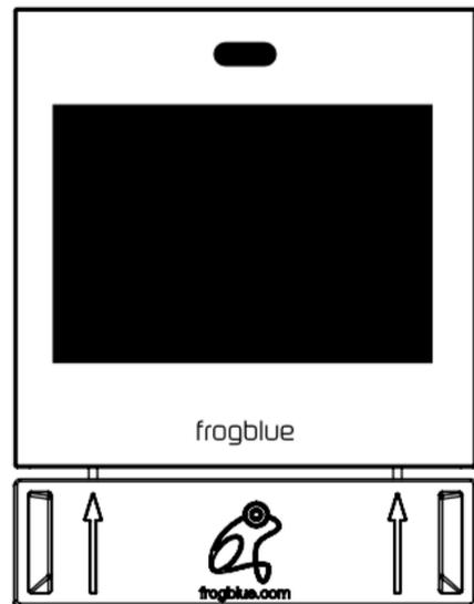
Das beiliegende Entriegelungswerkzeug, mit dem frogblue Logo nach vorne, an der Unterkante des Displays ansetzen, dabei müssen die Stifte des Entriegelungswerkzeugs vollständig in die 2 Löcher am unteren Rand des Displays eingeführt werden. Zum Schutz der Wandoberfläche bzw. bei rauen Untergründen ist die beigelegte Kunststoffolie unter das Entriegelungswerkzeug zu legen.
