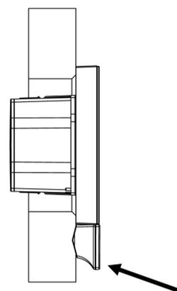
Das Entriegelungswerkzeug im unteren Bereich in Richtung Wand und leicht nach oben drücken.
