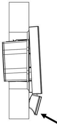
Dabei wird die untere Hälfte des Displays aus der Halterung geschoben.
