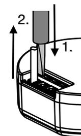
1. Entriegelung mit Schlitz-Schraubendreher (Gr. 3) drücken und halten
