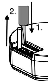
1. Entriegelung mit Schlitz-Schraubendreher (Gr. 3) drücken und halten
