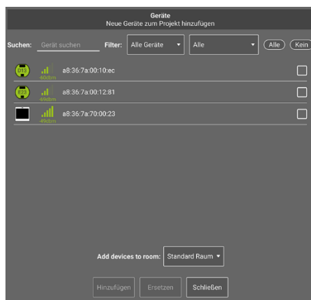
Abbildung: Über das Geräte Dialogfenster können Geräte zu einem Projekt hinzugefügt werden.
