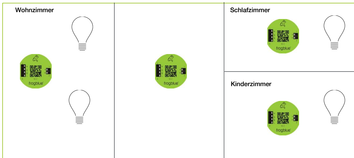
Abbildung: Zwischen Wohnzimmer, Schlafzimmer und Kinderzimmer wird ein zusätzlicher Frog geschaltet (schematische Darstellung).
