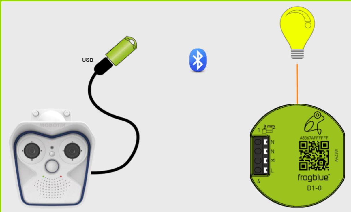
Über die USB-Schnittstelle der Mobotix-Kamera ist es möglich, den Bluetooth LE USB-Stick frogLink als serielle FTDI-Schnittstelle zu verbinden und somit eine Kommunikation mit den frogblue Komponenten herzustellen.
